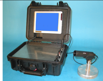
Valise de contrôle avec écran LCD 8 pouces
